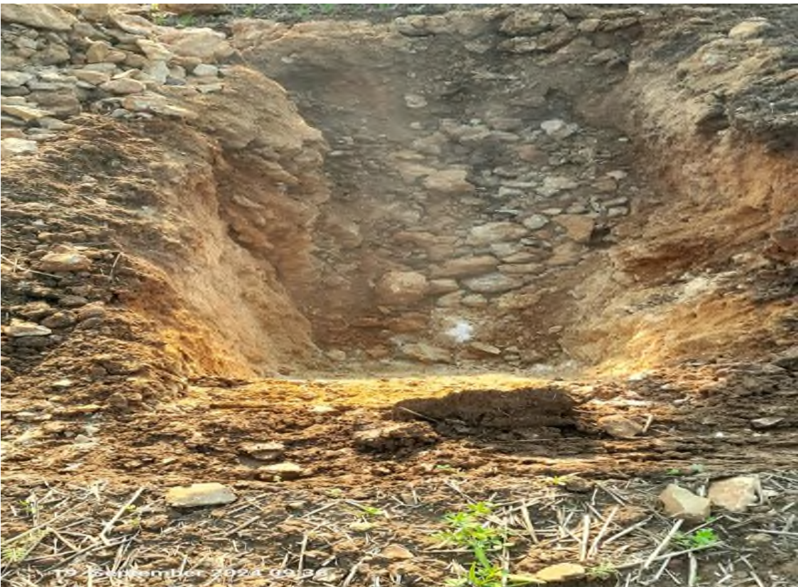
Bild 4: Baggerschurf U 2, Schurfgrube, T= 1,9 m, Steine/Blöcke mit Grus/Sanden (Kalkstein/Dolomit)
